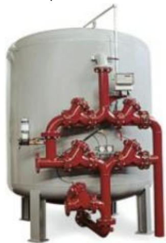
2. В стандартной комплектации управление диафрагменными клапанами фильтров осуществляется с помощью **гидравлических приводов, использующих для переключения циклов давление входящей исходной воды**. Отпадает необходимость дополнительного использования сжатого воздуха либо электроэнергии для управления клапанами и соответствующего вспомогательного оборудования. Конструкция применяемых диафрагменных клапанов с гидроприводами максимально проста и надежна в эксплуатации.
