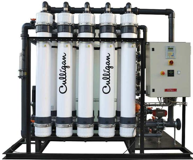
Ультрафильтрация - по рейтингу фильтрации воды занимает промежуточное положение между нанофильтрацией и микрофильтрацией. Ультрафильтрационные мембранные имеют размер пор от 20 до 1000 Å (или 0,002-0,1 мкм) и позволяют задерживать тонкодисперсные и коллоидные примеси, макромолекулы (нижний предел молекулярной массы составляет несколько тысяч), водоросли, одноклеточные микроорганизмы, цисты, бактерии и вирусы и т.д.
